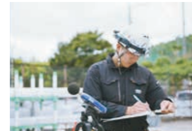
施工後の騒音測定
