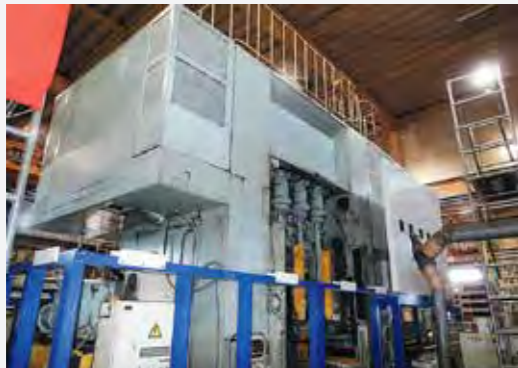
600t級のプレス機は騒音レベルが非常に大きく、作業エリア内での会話は不可能でした。
